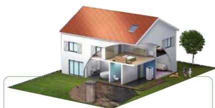
Captage sur sonde géothermique
