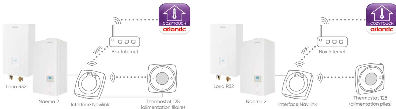
Ajouter un 2<sup>nd</sup> thermostat modulant connecté si 2 zones doivent être couvertes.
